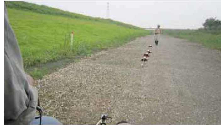
↑ 牽引式電気探査測定状況
