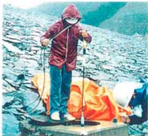
ダウンホール法圧着型受振器の挿入
