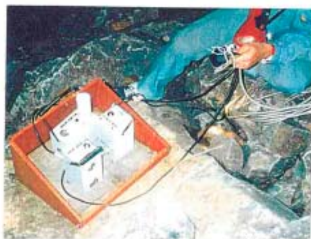
地表に設置された常時微動計
