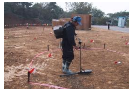
自社製の金属探知機による探査状況
