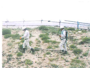
両コイル型磁気傾度計による磁気測定
