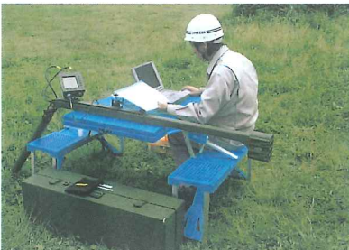
全磁力磁気探知器(3軸フラックスゲート型磁力計)による磁気測定
