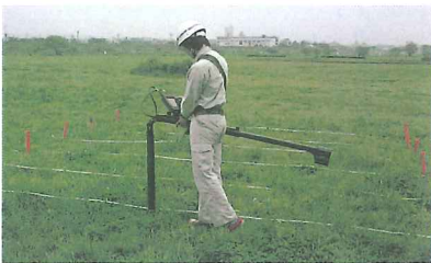
全磁力磁気探知器(3軸フラックスゲート型磁力計)による磁気測定
