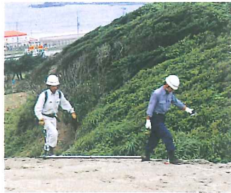
両コイル型磁気傾度計による磁気測定
