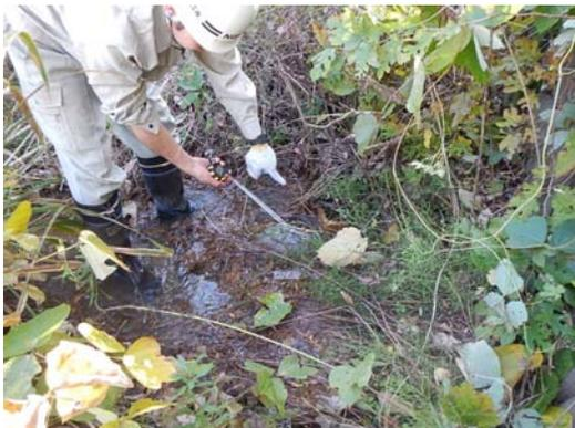
図3.5 目詰まりした排水管(上段)と擁壁下部より噴出する湧水(下段、指先の周囲には青灰色の砂層が分布)
