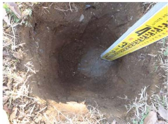
図3.4 レーダ探査により検知されたヒューム管
