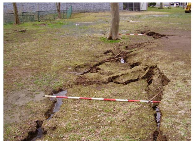
図2.3 地震により生じた液状化跡(富里市提供)
