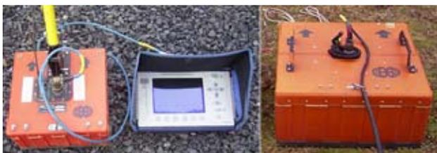
図3.1 レーダ探査に使用した探査機器（400MHzアンテナ，本体，200MHzアンテナ）
