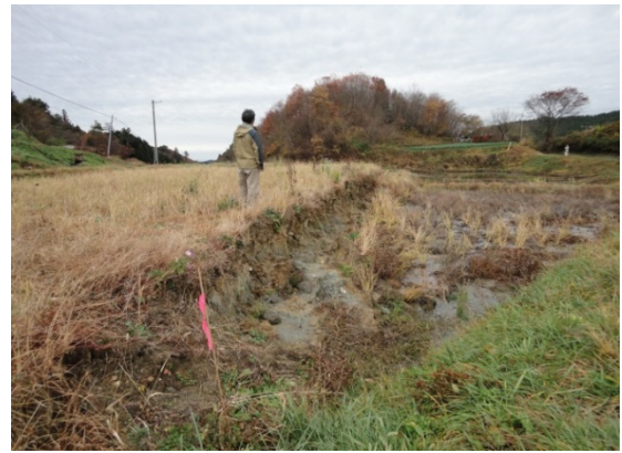
図15 阿寺断層に伴われる破碎帯 29) 花崗斑岩が20m以上にわたって破碎 岐阜県益田郡萩原町山之口付近
