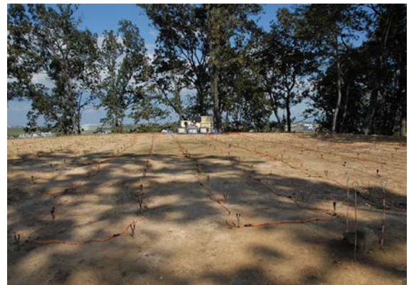
図3. 秋常山1号墳後円部墳頂での表面電位方による電気探査風景
