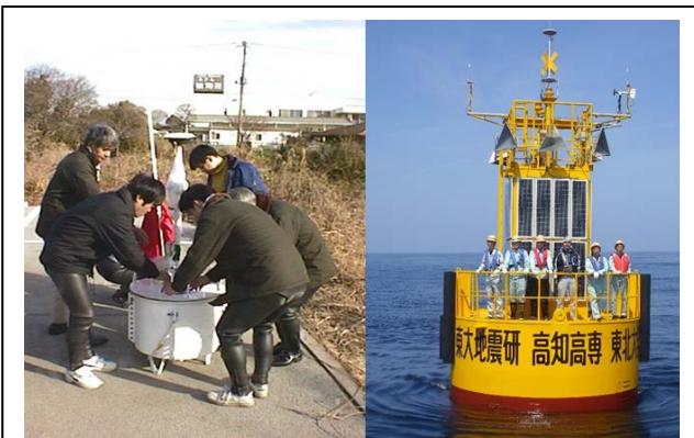
図2 GPS 津波計ブイ。(左) 白い缶体が1997年に試験的に製作したブイ。(右) 2013年に高知室戸岬沖に設置したブイ。
