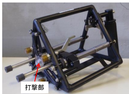
写真3-2 総研式打音検査装置（打撃装置）
