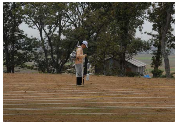
図4. 秋常山1号墳後円部墳頂での3軸グラジオメータによる磁気探査風景
