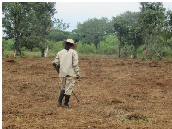
図-11 EMI センサーによる金属探査作業
