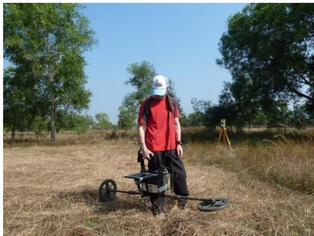
図-16 CMCA の不発弾検知訓練所での金属探知機による画像化実験
