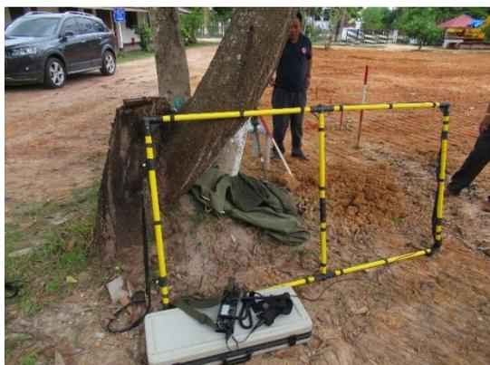
図-14 深部探査用金属探知機(Ebinger Type 740M)
