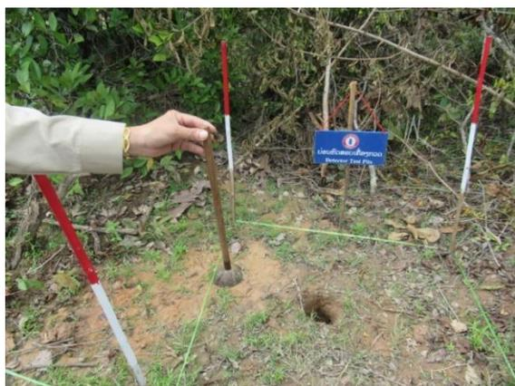
図-7 金属探知機校正用の標的物と校正に利用する孔
