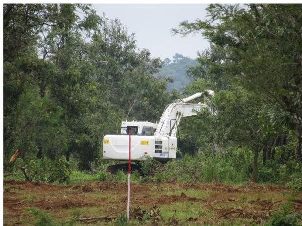
図-12 大型機械による刈り払い作業
