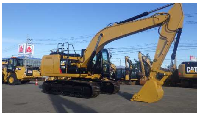
写真 3.1 油圧ショベル 320
