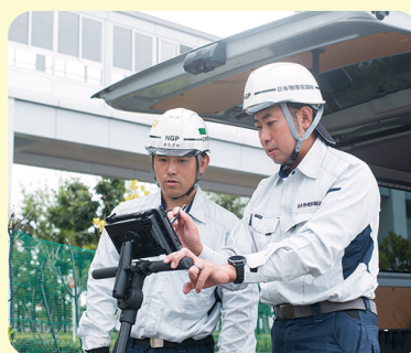
レーダを使って地面の中を覗き見る調査の様子
